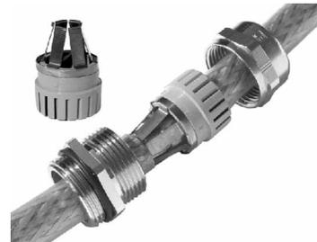
für Kabel und Leitungen mit Schirmung, schnelle und einfache EMV-Verbindung des Schirmgeflechts über die Kontaktfeder und den Zwischenstutzen mit dem Gehäusepotenzial.
